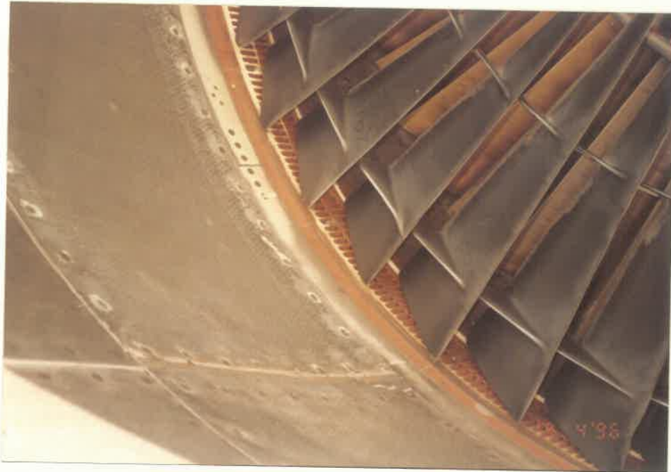
DAMAGED FAN BLADES
